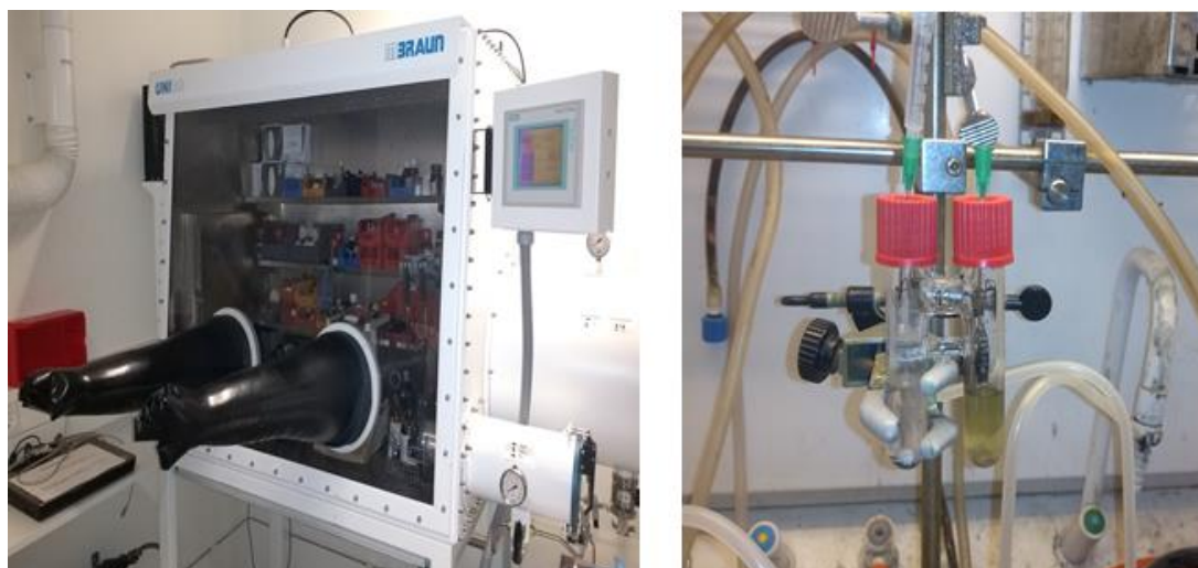
Figura 8: Fotografia da Glovebox onde foram realizadas as reações de carbonilação e a reação realizada fora da Glovebox , na capela do laboratório.
