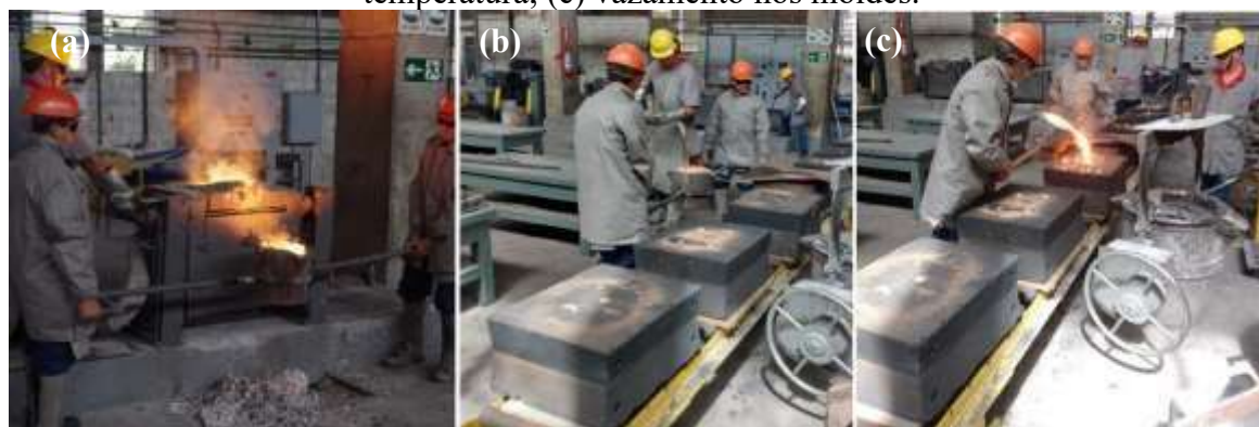
Figura 3.8- Obtenção dos corpos de prova: (a) fusão dos materiais de carga; (b) medição de temperatura; (c) vazamento nos moldes.
