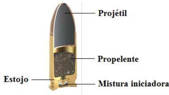
Figura 1.2: Componentes de um cartucho de munição (adaptado de CBC, 2013).
