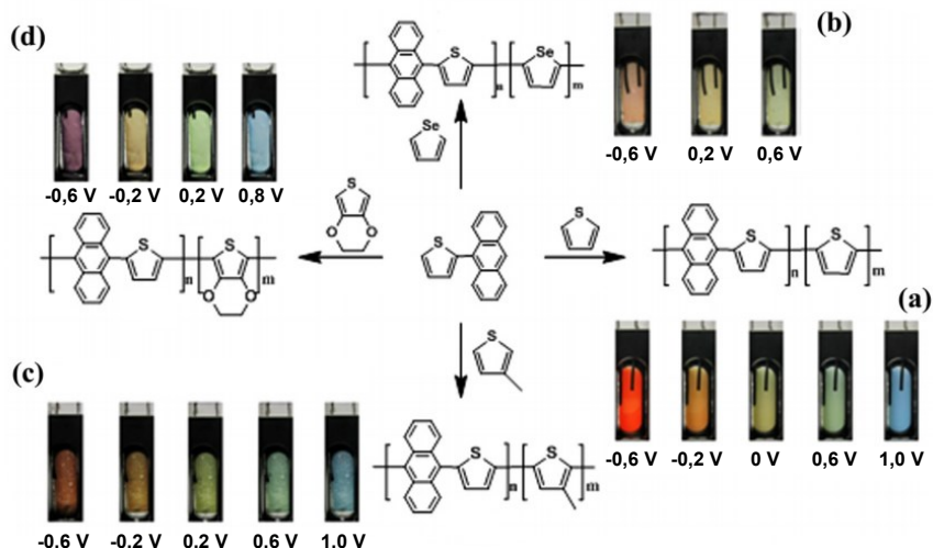
Figura 16 – Copolímeros multicoloridos constituídos por 2-(antracên-9-il)tiofeno e tiofeno (a), selenofeno (b), 3-metiltiofeno (c) e EDOT (d). Adaptado da literatura [175]
