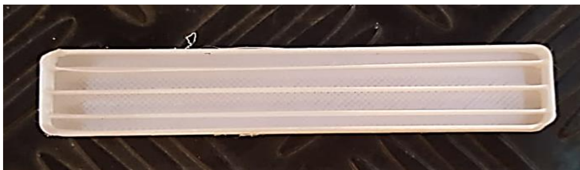
Figura 5.19 – Corpo de prova teste para parametrização do processo de impressão FDM
