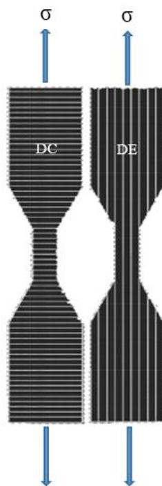
Figura 4.2 – Direção do esforço de tração nos corpos de prova impressos DC e DE (adaptado) (40)
