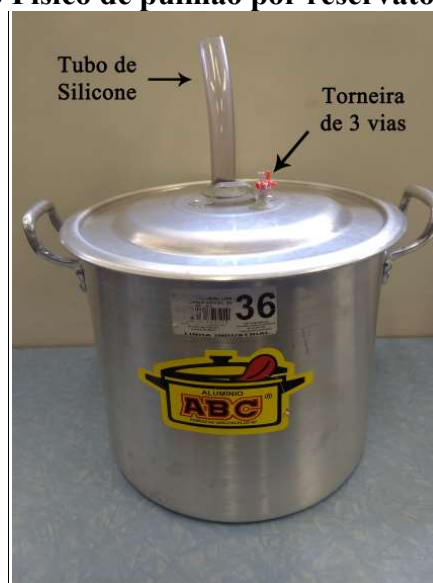
Figura 16 – Modelo Físico de pulmão por reservatório rígido construído
