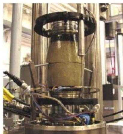
Detalhe para o corpo de prova salino ensaiado
