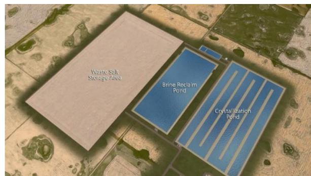
Figura 3. 22 Esquema simplificado dos tanques de cristalização de sais de potássio utilizado pela empresa Yancoal no Canadá. Fonte: Yancoal Canada (2016)
