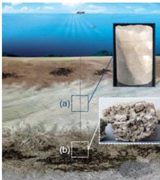
Figura 3.5 Esquemática do sistema petrolífero do pré-sal (a) evaporito (sal) e (b) carbonato. Fonte: Botelho (2017)
