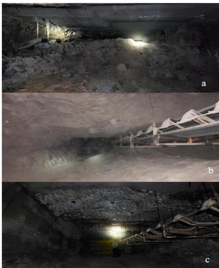
Figura 3.47- (a) e (b) galeria de retorno obstruída; (c) desobstrução da galeria de retorno. (Contribuição do autor, 2020).
