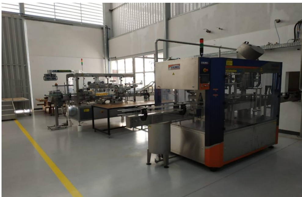
Figura 13 – Maquinário para envase e rotulagem das cervejas
