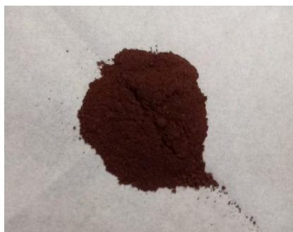
Figura 10. Hexacianoferrato de cobre (CuHCF) obtido neste estudo.
