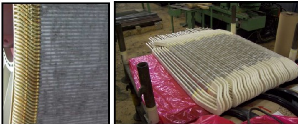
Figura 27 - Bobinas pré-moldadas (Fonte: Descrição técnica do parque em estudo)
