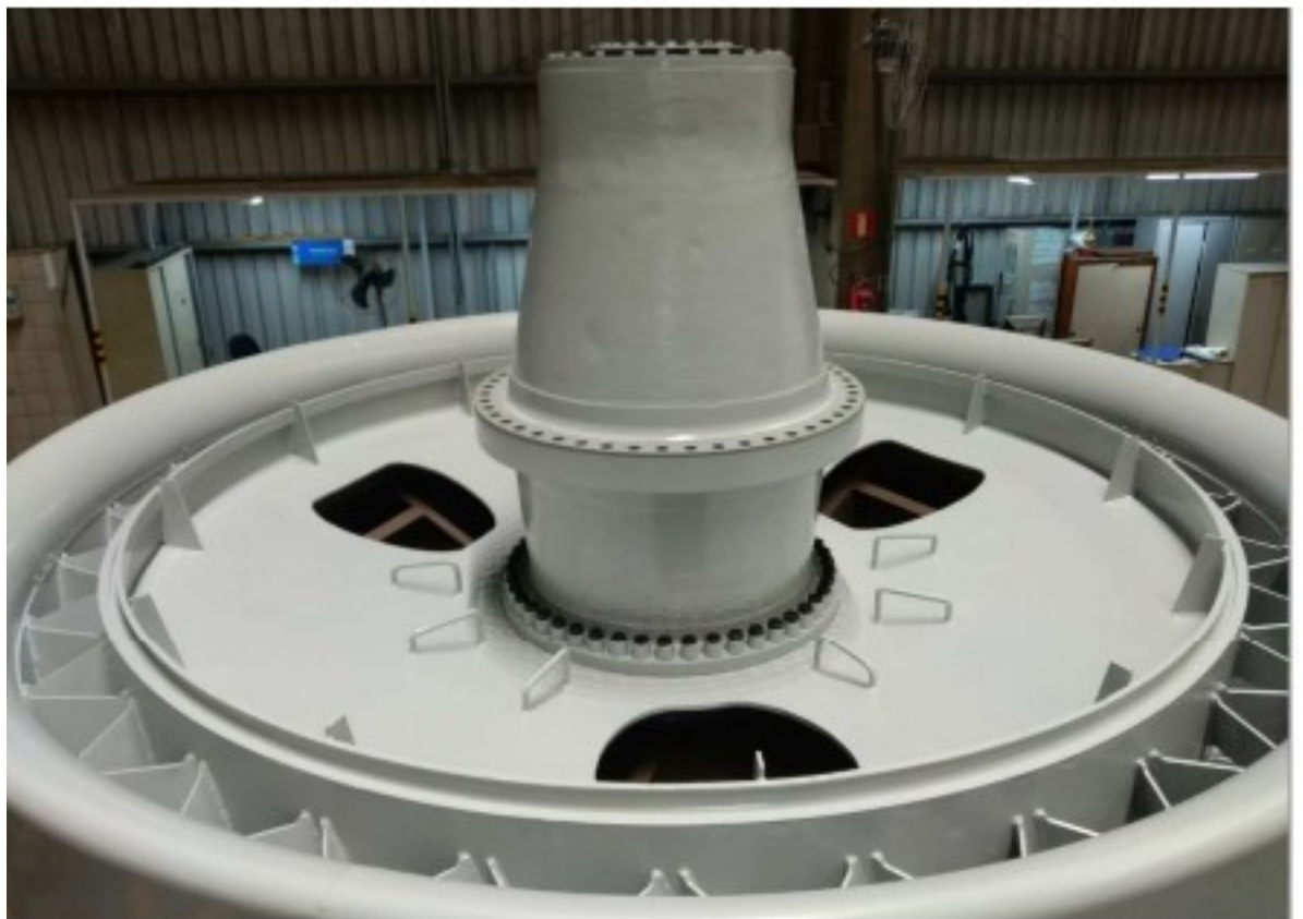
Figura 55 - Partes do Aerogerador após recuperação (Fonte: Empresa proprietária do parque)
