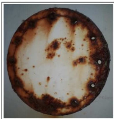
Figura 47 - Pontos de oxidação na carcaça do aerogerador (fonte: Empresa proprietária do parque)
