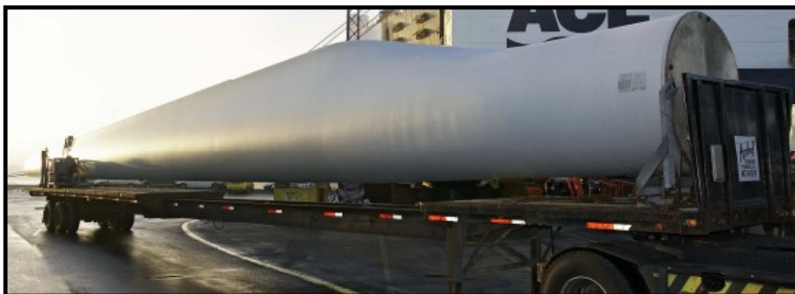
Figura 31 - Pá do aerogerador do parque em estudo (34 metros de comprimento e 5.720 kg) (Fonte: Descrição técnica do parque em estudo)
