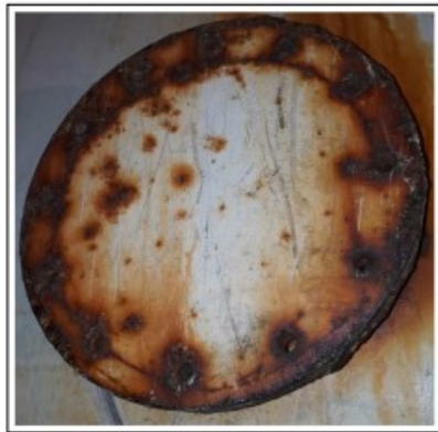
Figura 48 - Exemplo de oxidação acentuada em alguns pontos (fonte: Empresa proprietária do parque)
