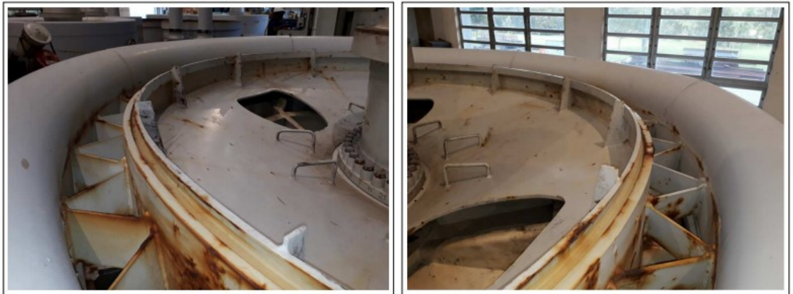
Figura 47 - Pontos de oxidação na carcaça do aerogerador (fonte: Empresa proprietária do parque)
