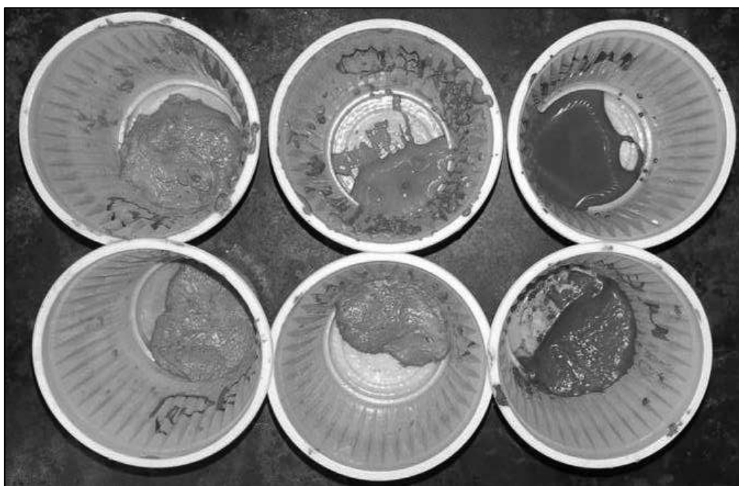
Figura 8: Geopolímeros de caulinita e metacaulinita após adição da solução ativadora básica.
