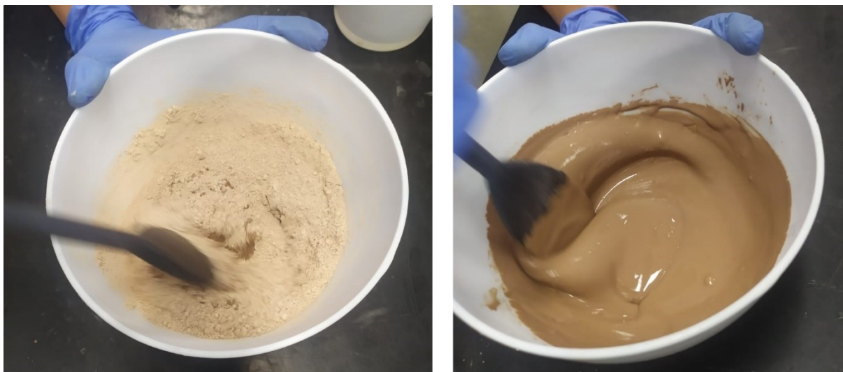
Figura 4.3 – Etapa de mistura do metacaulim com o ativador alcalino líquido durante o preparo das amostras de geopolímero à base de metacaulim.
