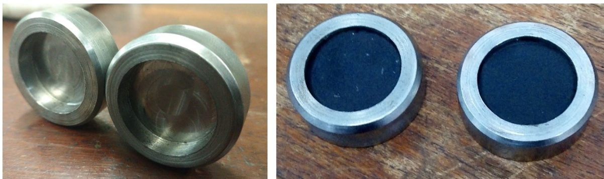
Figura 4.5 – Peças metálicas com disco de neoprene usados no ensaio de resistência a compressão das amostras de geopolímero.
