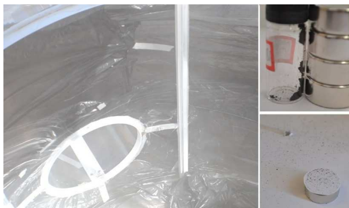
Figura 15 - Experimentos para calibração da CTA. À esquerda, teste de alcance e distribuição com fumaça branca; à direita (acima) demonstração do magnetismo da amostra de MWCNT; à direita (abaixo) experimento de deposição para teste das armadilhas com ímãs
