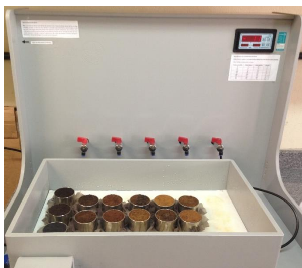
Figura 12 Amostras indeformadas na mesa de tensão
