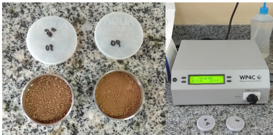
Figura 14 Amostras em cápsulas de aço inoxidável e WP4C
