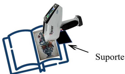
Figura 10. Esquema representativo para a realização das medidas de EDXRF. Fonte: autoral.
