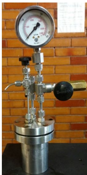
Figura 12: Autoclave de aço inoxidável equipada com manômetro e amostrador para retirada de alíquotas (Fonte: elaborado pela autora).
