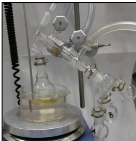
Figura 13: Sistema de destilação sob pressão reduzida com três coletores (Disponível em: http://www.orgsyn.org/demo.aspx?prep=v93p0367 , acesso em 11/10/2019)
