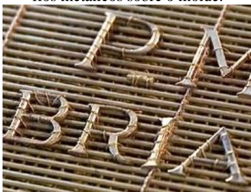
Figura 21 - Detalhe de letras aplicadas com fios metálicos sobre o molde.
