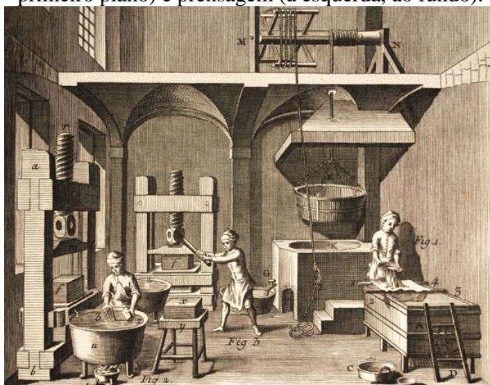
Figura 16 - Filtragem da solução de encolagem (à direita), encolagem das folhas (em primeiro plano) e prensagem (à esquerda, ao fundo).
