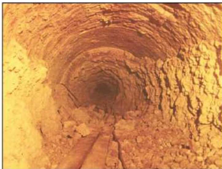
Figura 3.18 - Anel formado em um forno de cal Fonte: TRAN (2007)
