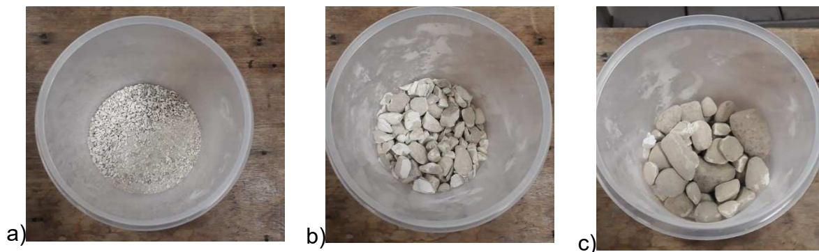
Figura 5.1 - Cales separadas nas faixas granulométricas de a) 0 a 3 mm; b) 3 a 19 mm; c) 19 a 40 mm; a partir da amostra-mãe
