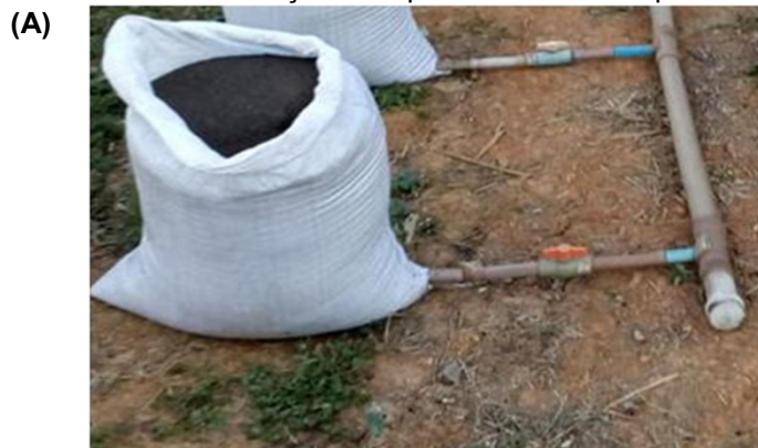
Figura 2 – (A) Exemplo da aeração por unidade experimental, com tubos de PVC de 50mm e 25mm com um registro acoplado, (B) Tubo de PVC de 25mm após o registro posicionado ao fundo da unidade experimental com 4 furos de 10mm e coberto com sombrite para evitar entupimento, (C) visão geral do sistema de aeração nos quatro blocos do experimento
