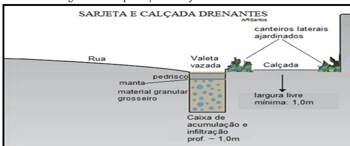
Figuras 12 – Implantação de Sarjetas drenantes
