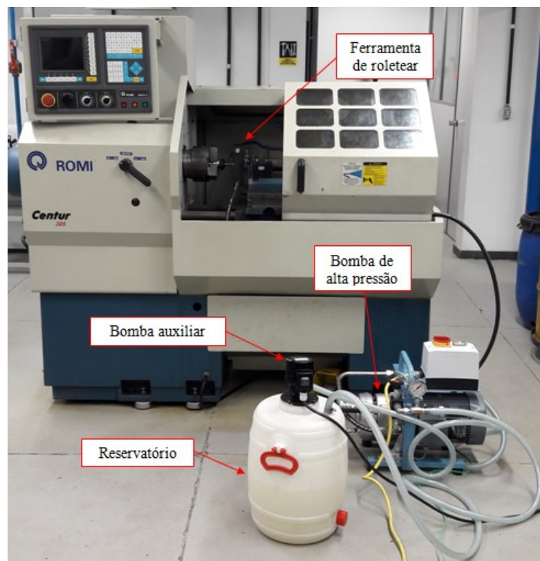
FIGURA 3.3 – Montagem do equipamento de roletear no torno.
