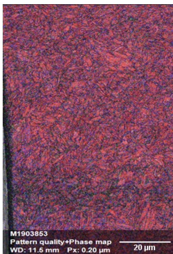
FIGURA 4.48 – Distribuição de fases da amostra roleteada com P_r = 200 bar, V_r = 30 m/min e f_r = 0,06 m/volta.
