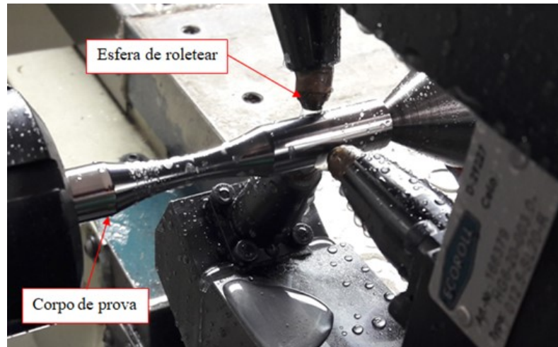
FIGURA 3.4 – Ferramenta de roletear acoplada a torre do torno.
