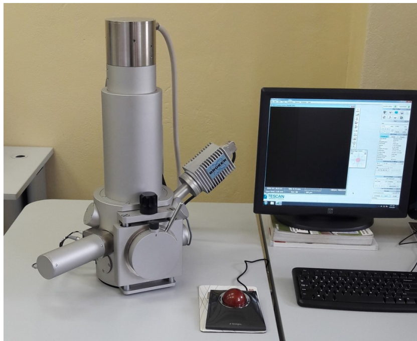
FIGURA 3.7 – Microscópio eletrônico de varredura utilizado na análise das fraturas.
