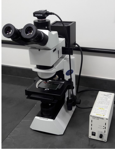
FIGURA 3.8 – Microscópio óptico, câmera e fonte externa utilizados na MO.
