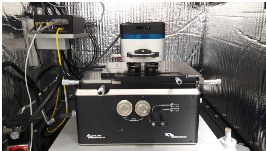
FIGURA 3.9 – Microscópio de força atômica utilizado na nanoindentação e topografia.
