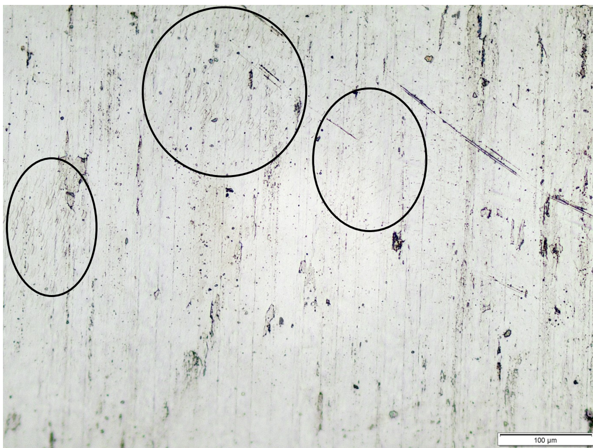
FIGURA 4.38 – Presença de marcas em forma de arco (interior dos círculos ou elipses pretos) no corpo de prova roleteado com P_r = 200 bar, V_r = 30 m/min e f_r = 0,09 mm/volta.
