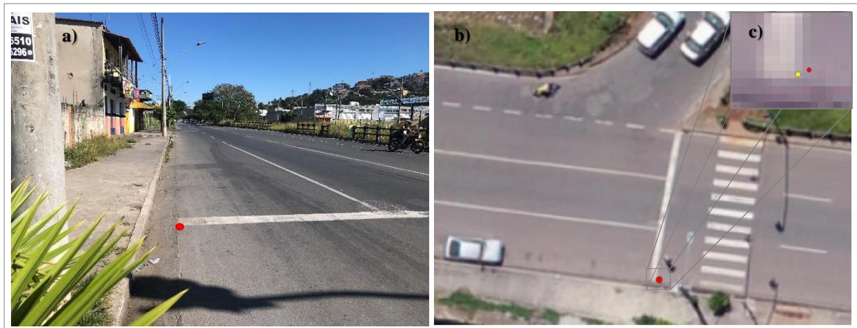
Figura 3.09 – Verificação da DisPos. a) Local de coleta em campo; b) local de correspondência no ortomosaico; c) discrepância posicional do ponto = 15cm. Fonte: Elaborado pelo autor a partir do estudo de caso bairro Confisco, BH/Contagem (2019).
