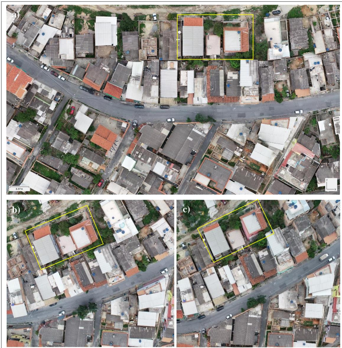
Figura 2.06 – Imagem ortorretificada com MDT comparada com imagens originais. a) Imagem ortorretificada; b) e c) fotografias aéreas originais. O polígono amarelo exemplifica a transformação cônica para a ortogonal.
