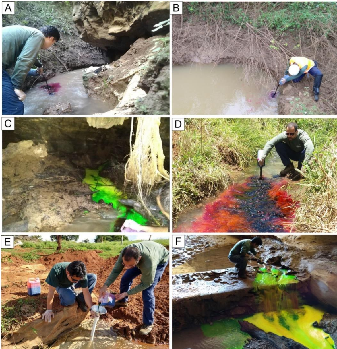
Figura 16 - Injeção dos traçadores fluorescentes. A) Injeção de Rodamina WT na gruta do Zé Irene (ID-37; Ensaio 6); B) Injeção de Rodamina WT na lagoa do Bom Jardim (ID-40; Ensaio 7 e 8); C) Injeção de Fluoresceína no sumidouro Palmeiras (ID-41; Ensaio 7 e 8); D) Injeção de Rodamina WT no sumidouro Bebidas (ID-44; Ensaio 9); E) Injeção de Fluoresceína no sumidouro Goiabeiras (ID-43; Ensaio 9); F) Injeção de Fluoresceína na gruta da Lapa vermelha (ID-52; Ensaio 10).
