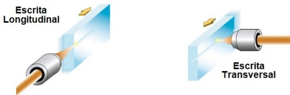
Figura 7.2: Diferentes formas de fabricar dispositivos fotônicos utilizando a técnica da Escrita Direta. Figura adaptada da referência [33].
