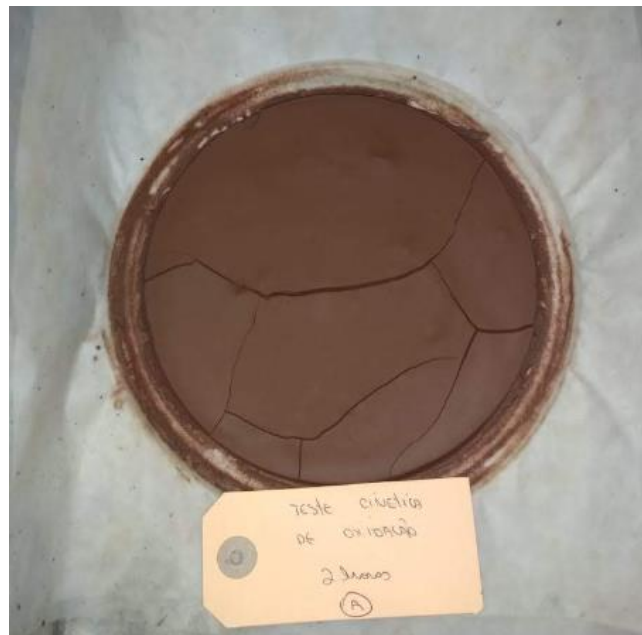
Figura 18: Material filtrado após ensaio de oxidação de uma hora com sistema semiaberto.
