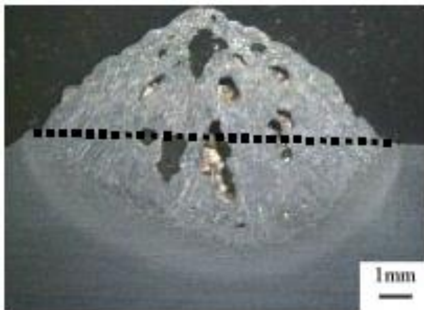
Figura 3.7 - Poros no metal de solda [28].
