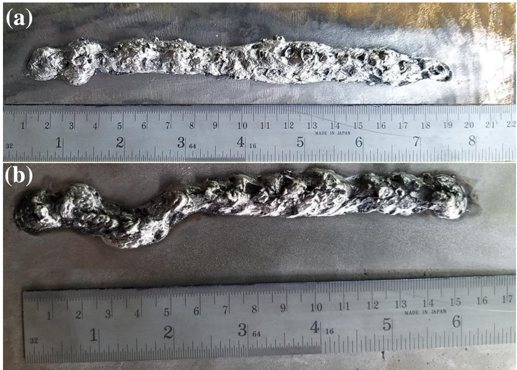
Figura 5. 15 - Cordões de solda obtidos na soldagem subaquática com o eletrodo A6 (a) no aço carbono; (b) no aço inoxidável.
