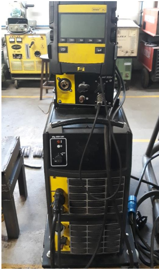
Figura 4.3 - Fonte de energia e alimentador de arame para soldagem FCAW.
