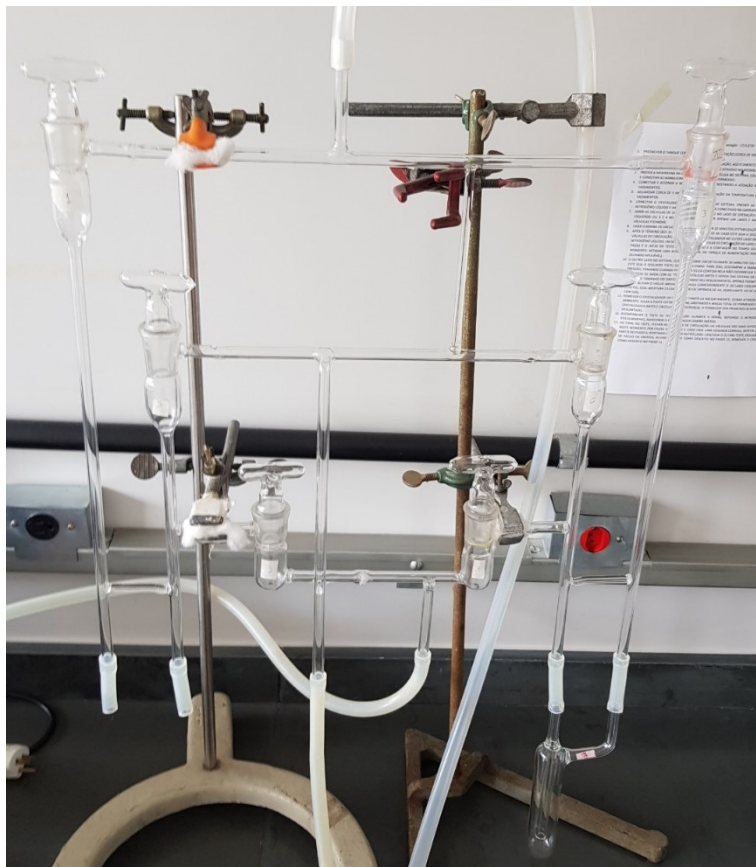
Figura 4.1 - Projeto (a) e fotografia (b) da grade de pervaporação. Fonte: Próprio autor.
