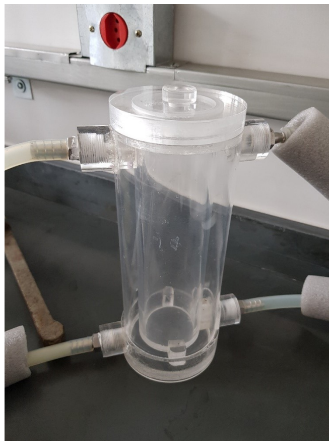
Figura 4.2 – Projeto (a) e fotografia (b) do tanque de alimentação. Fonte: Próprio autor.
