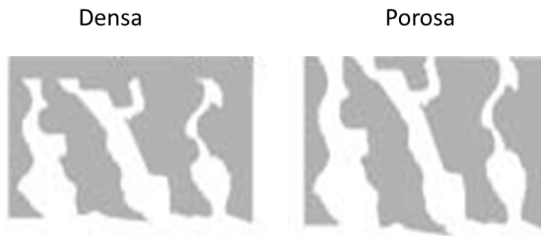
Figura 3.3 - Esquema de morfologias de membrana anisotrópicas, seção transversal. Fonte: Adaptado de HABERT et al., 2006.
