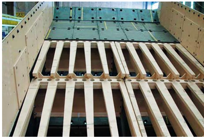
Figura 3.3. Ilustração de grelha vibratória. Meio peneirante: Chapas perfuradas na alimentação e barras de aço ( fingers ) ao longo do deck – (Metso, 2018a)
