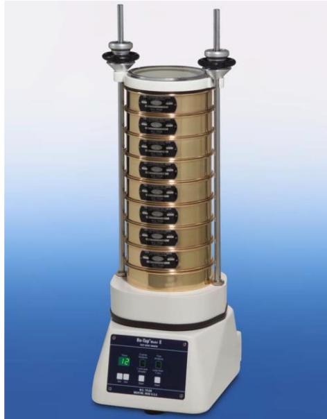
Figura 3.31. Conjunto de peneiras em série sobre agitador mecânico com temporizador e controle de vibração (TYLER, 2017).
