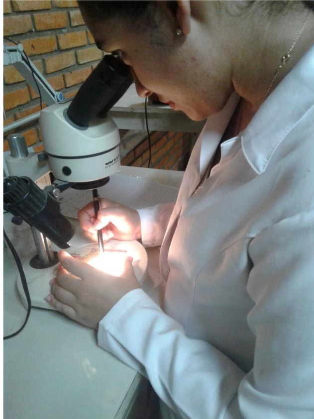
Figura 4.6. Contagem de partículas irregulares na fração <3,36\text{mm} e >0,149\text{mm} por lupa binocular, aumento de 4x.
