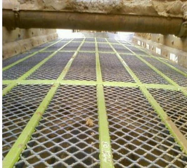
Figura 3.17. Tela autolimpante Flexmat® tensionada – Forma da abertura: diamante (HAVER & BOECKER, 2005).
