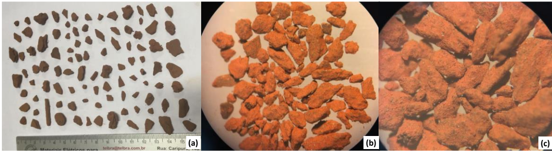
Figura 4.8. Imagem da amostra de hematita (Am18) destinada à análise do índice de forma – (a) Fração >3,36\text{mm} (b) Fração <3,36>0,149\text{mm} , aumento de 2x (c) Fração <3,36>0,149\text{mm} , aumento de 4x.
