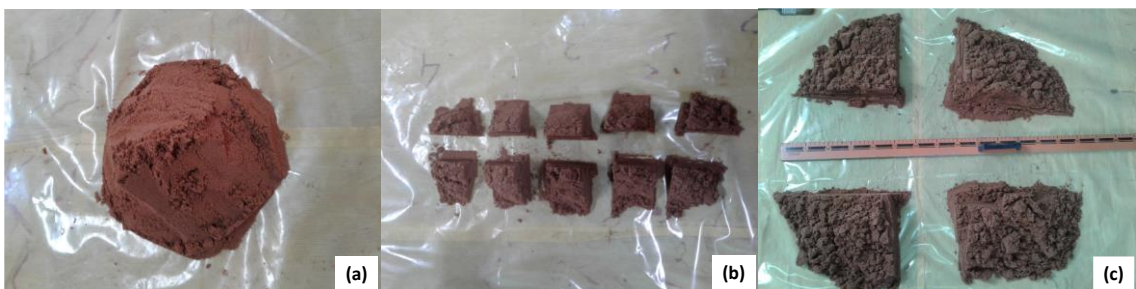
Figura 4.3. Etapas de preparação da amostra de bauxita Am37 - (a) Lote inicial. (b) Pilha alongada. (c) Pilha cônica.
