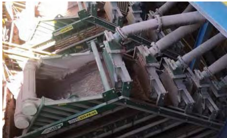
Figura 3.11. Exemplo de uma peneira de alta frequência em produção na Votorantim – Vazante (REVISTA MINÉRIOS, 2018).
