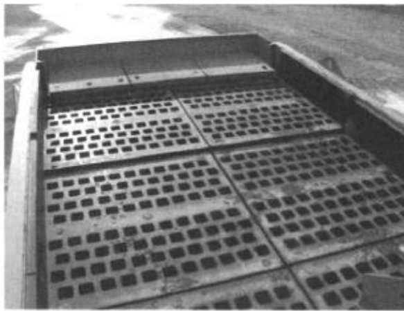
Figura 3.14. Chapas de aço perfuradas aparafusadas sobre deck de uma peneira (WILLS, 2006).
