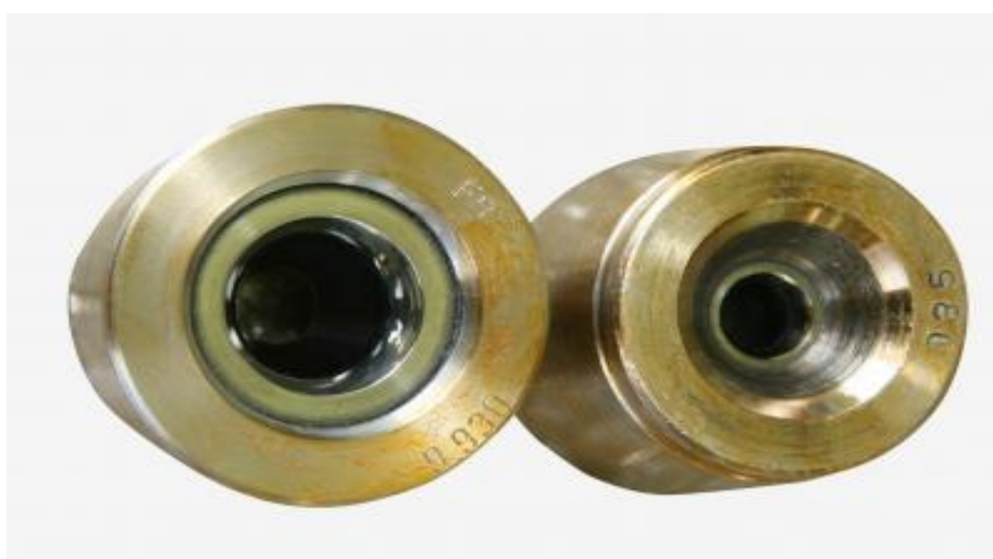
Figura 3.2- Fieiras para o processo de trefilação
