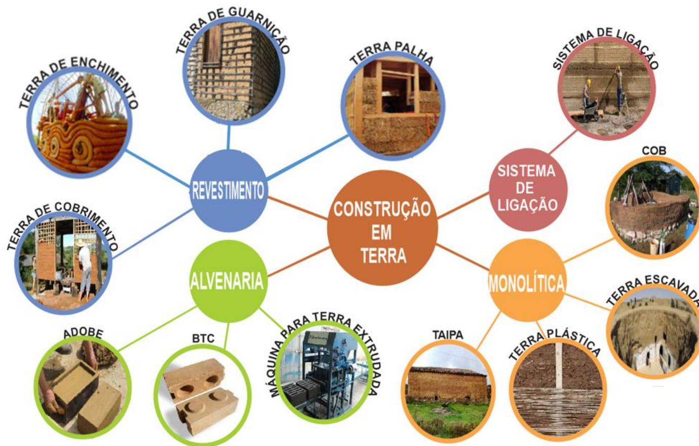
Figura 3.9: Diagrama simplificado dos diferentes grupos de sistemas construtivos que utilizam a terra como matéria-prima (Monolítica, Alvenaria, Por Enchimento e Revestimento e Sistemas de ligação)<sup>8</sup>.
