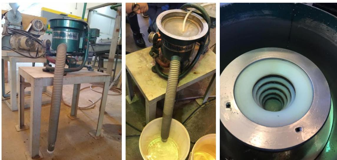
Figura 4.3: Concentrador centrífugo Knelson.
