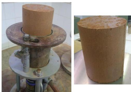
Figura 4.4: Extrator de corpo de prova à esquerda e corpo de prova desmoldado a direita.
