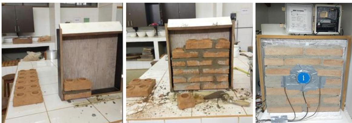
Figura 4.7: Construção do corpo de prova – parede de tijolos tipo solo-cimento.
