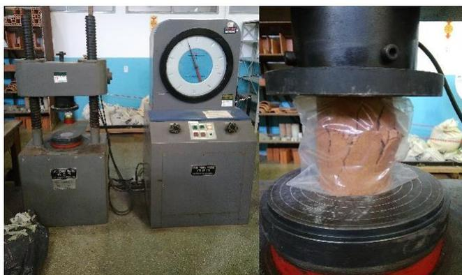
Figura 4.5: Prensa para o teste de resistência à compressão uniaxial (esquerda) e corpo de prova cilíndrico sendo prensado (direita).
