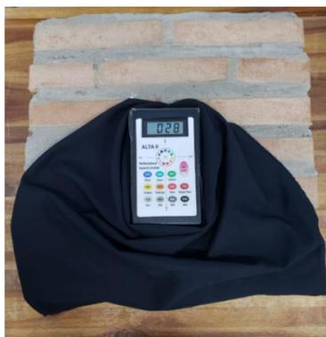
Figura 4.8: Utilização do espectrômetro ALTA II para medição da refletância do corpo de prova.
