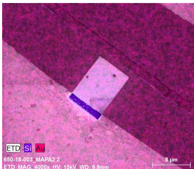
Figura 16 - Imagem de EDS da amostra pronta revelando a sua composição. atômica.
