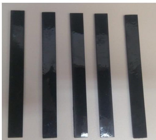
Figura 4.7 – Imagem dos corpos de prova de flexão dos compósitos por misturador de alta intensidade (DRAIS).
