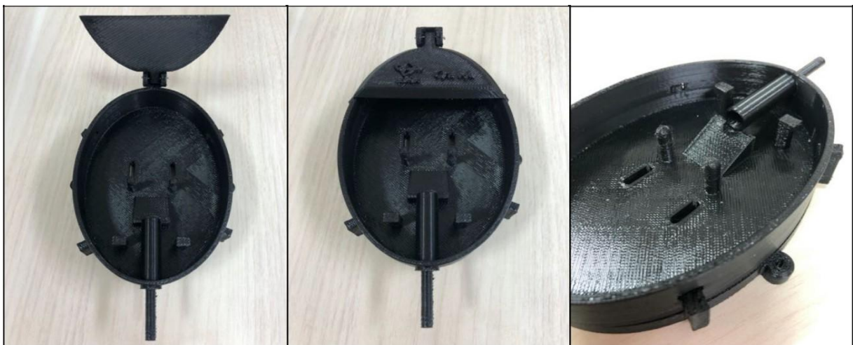
Figura A – Mesa cirúrgica personalizada confeccionada através da impressão 3D.
