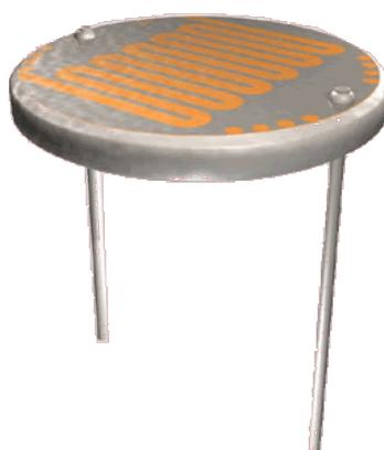
Figura 26 – Fotocondutor de CdS comercial típico.
