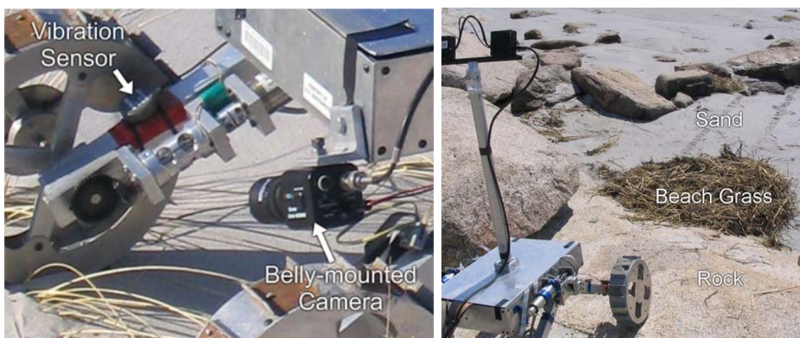
Figura 2.10: Veículo utilizado durante os experimentos e disposição dos sensores acoplados [Brooks & Iagnemma, 2007].
