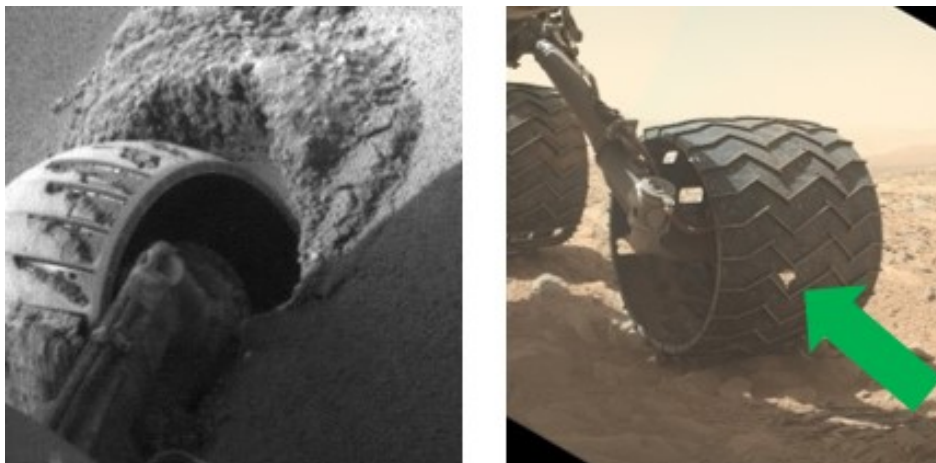
Figura 2.1: Exemplos de imagens capturadas durante o deslocamento, com ênfase nas maiores dificuldades encontradas durante a navegação em Marte: atolamento das rodas e pedras pontiagudas que furam as rodas [Ono et al., 2015].
