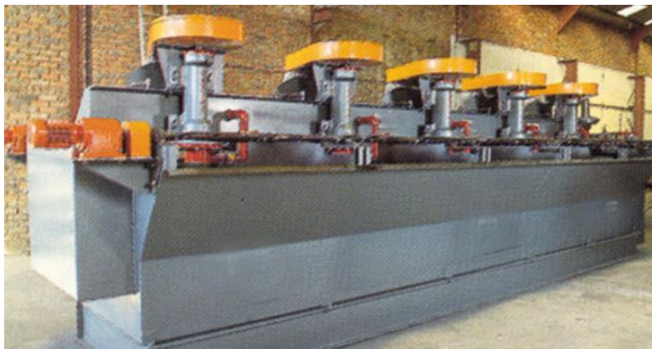
Figura 3.16. Modelo de célula de flotação convencional.
