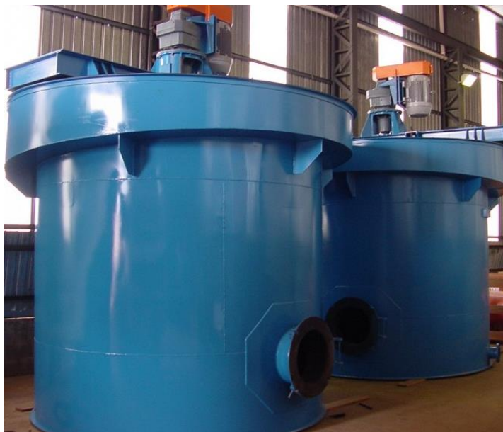
Figura 3.19. Tanque de condicionamento de polpa.
