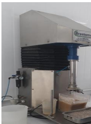
Figura 4.3. Célula de bancada da AMG-Mineração.
