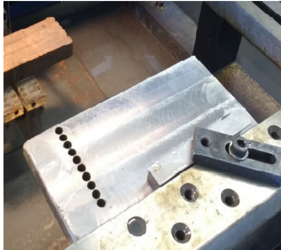
Figura 4.4 Detalhe do corte dos pinos por EDM (autoria própria, 2017).
