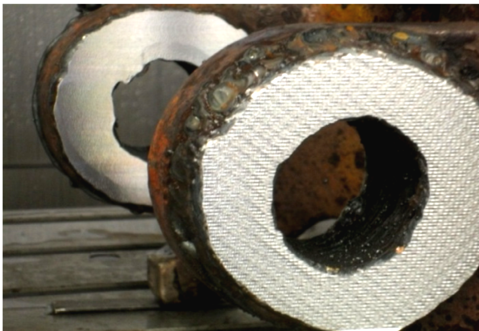
Figura 3.7 Mancais axiais do braço articulável (autoria própria, 2014).
