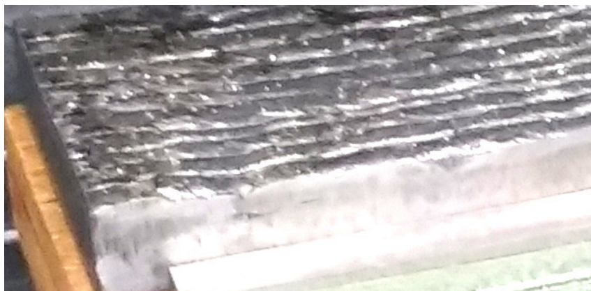
Figura 4.2 Revestimento da liga MnSi sobre substrato de aço ABNT 1015 (200 mm x 100 mm x 15 mm), (autoria própria, 2017).
