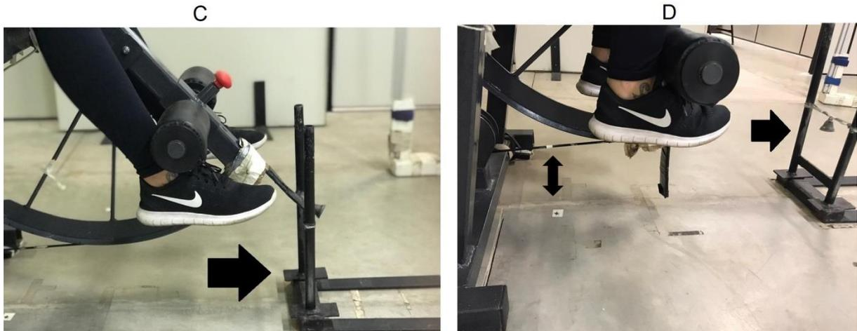
A Figura 6A destaca o espelho e o levante manual de pesos. A Figura 6B realça o prolongamento metálico do braço mecânico e as hastes de controle da amplitude de movimento até  $30^\circ$ . A Figura 6C ilustra a outra haste de controle de amplitude de movimento até  $65^\circ$ . A Figura 6D ilustra a marcação no chão alinhada à marcação no cabo, sinalizando  $100^\circ$  de flexão de joelho, e o sino.
