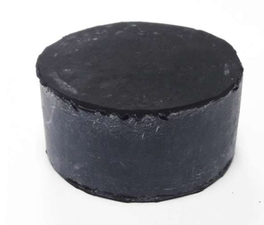
Figura 15 – Exemplo de corpo de prova utilizado no teste de compressão
