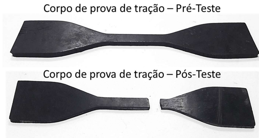
Figura 13 – Exemplo de corpo de prova utilizado no teste de tração
