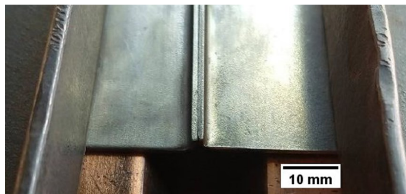
Figura 51 – Corpo de prova fixado a dispositivo para soldagem GMAW (Próprio autor)
