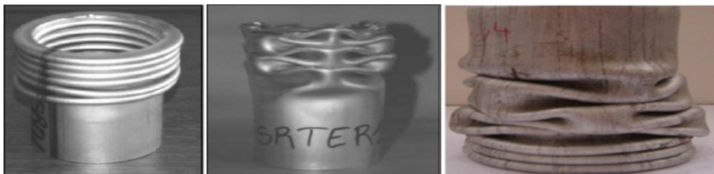
Figura 25 - Da esquerda para a direita: Modo concertina, modo diamante, modo misto. (AL GALIB e LIMAM, 2004)
