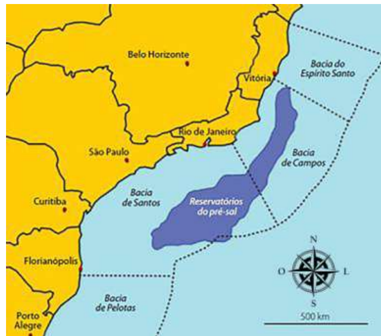
FIGURA 4. Distribuição das rochas reservatórios do Pré-sal (em azul escuro) em relação às bacias sedimentares da margem continental sudeste brasileira. Fonte: Riccomini et al. (2012).
