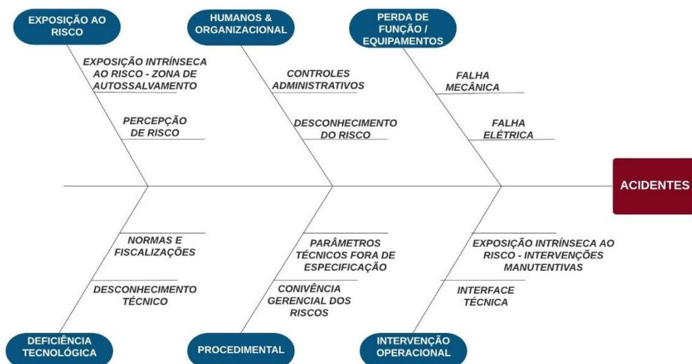
Figura 12 - Diagrama de Causa e Efeito para as principais causas mapeadas que ensejam acidentes ampliados. Fonte: O autor (2020).
