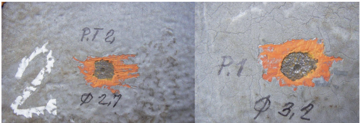
Figura 4 – Medições de dureza nos principais elementos da estrutura.
