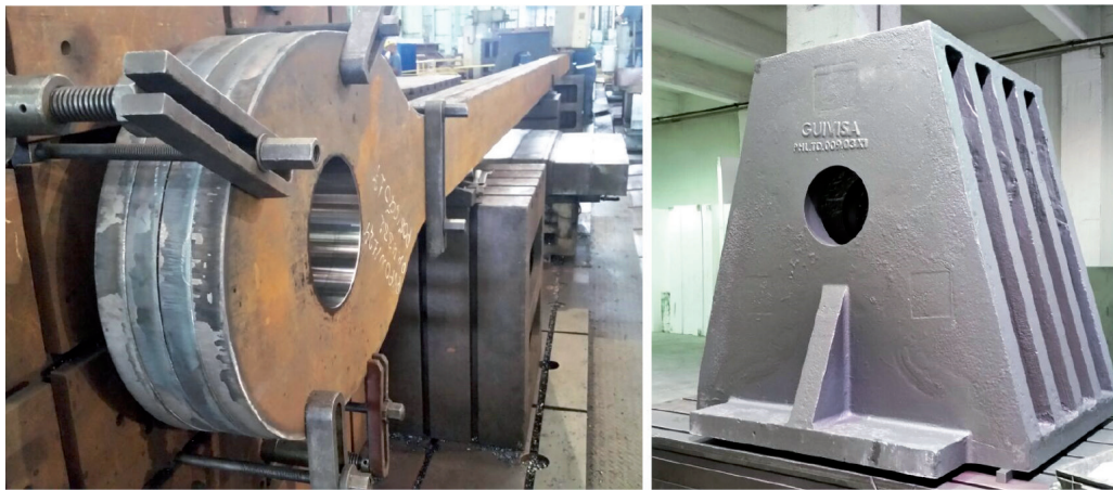
Figura 14 – Fabricação das barras de olhais e selas.
