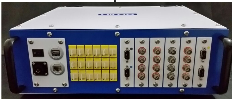
Figura 30 – Gabinete com módulos para controle e coleta de dados
