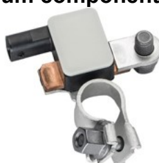
Figura 13 – Ilustração de um componente IBS e sua estrutura
