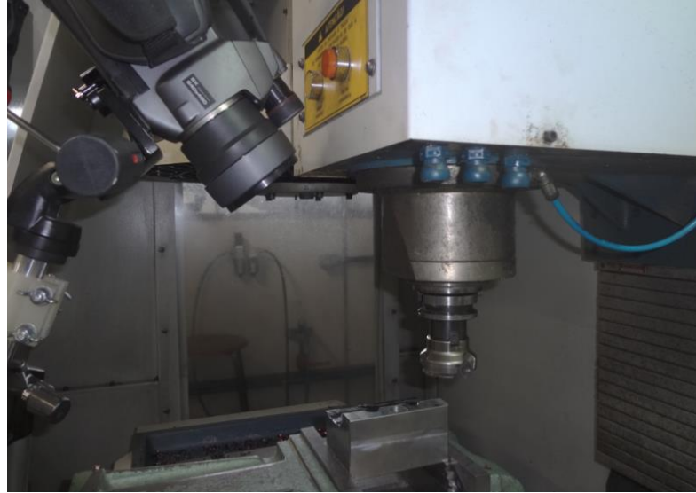
FIGURA 3.9 - Configuração do experimento para medição da temperatura.
