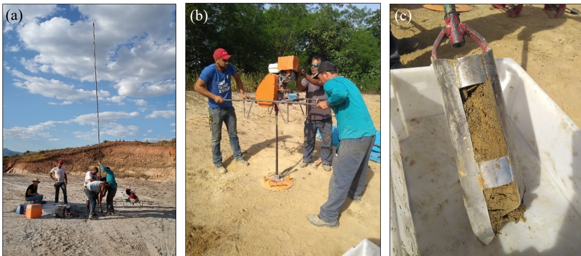
Figura 6 - (a) Coleta de amostras em um dos depósitos estudados, por meio de (b) trado mecanizado e (c) detalhe do amostrador com o resíduo de LBRO, coletado em profundidade.
