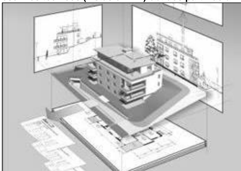
Figura 5 - Desenhos técnicos (vistas em 2D) obtidos partir de um modelo BIM
