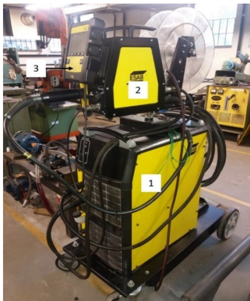
Figura 3.6 - (1) Fonte eletrônica, (2) sistema de alimentação de arame e (3) controlador
