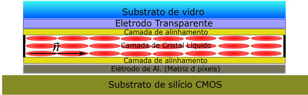
Figura 1.1: Representação da estrutura de um LCOS-SLM. Nesse tipo de tecnologia uma célula de cristal líquido é acomodada sobre um substrato de silício. A camada superior a este substrato contém píxeis feitos de eletrodos de alumínio, e um substrato de material transparente que contém ranhuras é posicionado acima do eletrodo de alumínio, formando uma camada de alinhamento. Espaçadores são utilizados para se criar um gap entre essa estrutura prévia e uma estrutura composta por um eletrodo transparente e um substrato de vidro. (Baseada na ref. [1])
